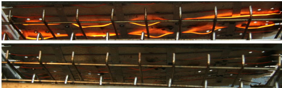
Obrázek 6 Rozžhavený odporový drát v topinkovači po výměně (dole s paralelně zapojeným drátem navíc).
